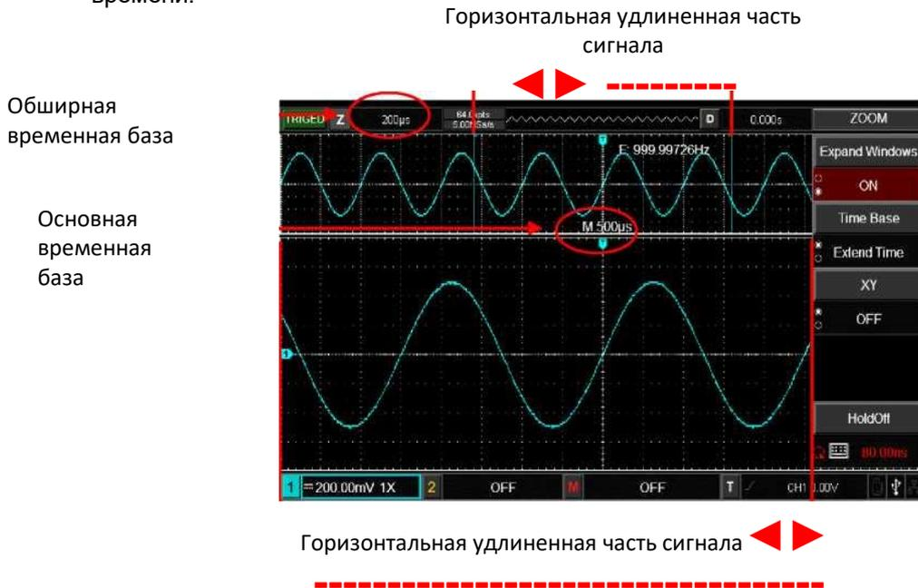
Рисунок 3-2 Отображение экрана в расширении окна
