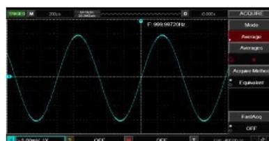
Рисунок 5-1. Метод сбора данных без усреднения. Рисунок 5-2. Сбор данных усреднения из 8 чисел.
