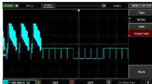
Рисунок 4-2 Видеозапуск: синхронизация поля
