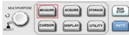
Рисунок 7-1 Функциональная клавиша автоматического измерения
