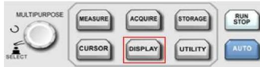
Рисунок 6-1 Функциональные клавиши системы отображения
