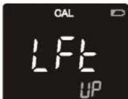
В это время мигает символ «CAL». «LFt Up» означает, что датчик необходимо поднять (вдали от металлических предметов и сильных электромагнитных полей) и нажать кнопку, чтобы выполнить компенсацию датчика. После завершения компенсации он входит в точку калибровки нуля, и на ЖК-дисплее отображается следующее:
