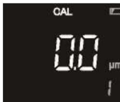
На ЖК-дисплее отображается 0.0m, а в правом нижнем углу отображается номер калибровки «1». Прижмите щуп манометра к прикрепленной непокрытой подложке, чтобы выполнить калибровку нулевой точки. Датчик автоматически определит, является ли это подложкой из черных металлов или подложки из цветных металлов.
