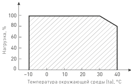
Рис. 2. Максимальная допустимая нагрузка, % от мощности источника
